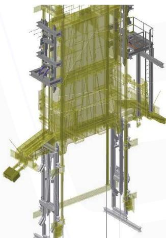
Rys. 5.3 Zabudowane konstrukcje prowadzenia ruchomego (kolor szary) [13]
