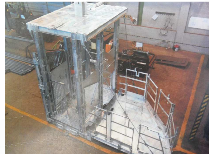
Rys. 2.1 Naczynie wyciągowe specjalnego przeznaczenia [8].
