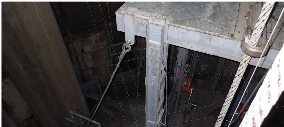
Rys. 2.8 Naczynie specjalnego przeznaczenia z rozłożonymi podestami uchyłnymi [8]
